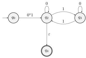
(d) We have  $R_1=1,\,R_2=0,\,R_3=\emptyset,$  and  $R_4=\varepsilon$ :
